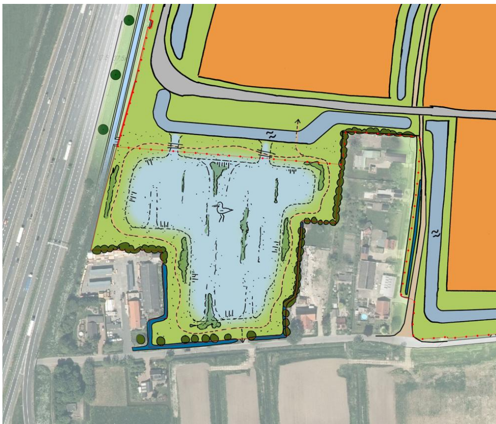
Schetsontwerp toekomstige waterhuishouding bedrijventerrein, met ligging retentiegebied
